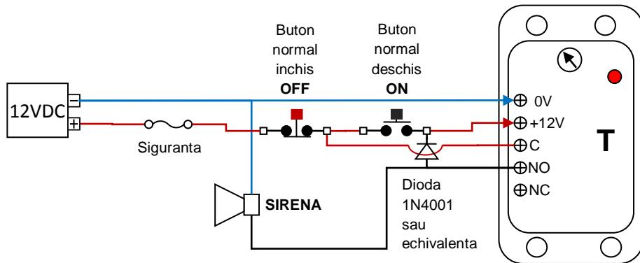
Stabilirea duratei minime de apasare a unui buton pentru actionarea unei alarme (sau a altui dispozitiv)
